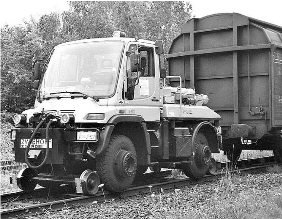
Abb.38: Der „Unimog“ von Daimler Benz kann mit klappbaren Führungsrollen auch auf Schienen fahren und wie eine Rangierlokomotive eingesetzt werden.
