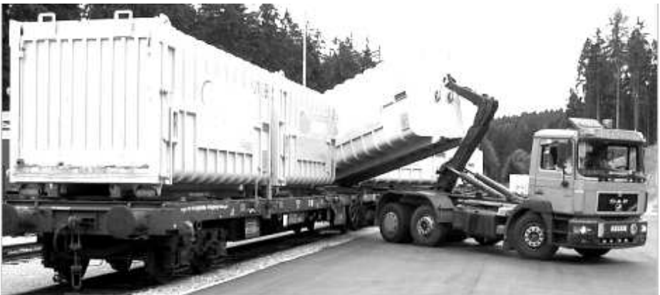
Abb.41b: Das Umladen eines Abrollcontainers vom Flachwagen auf den LKW aus einem anderen Blickwinkel als in Abb.41a.
