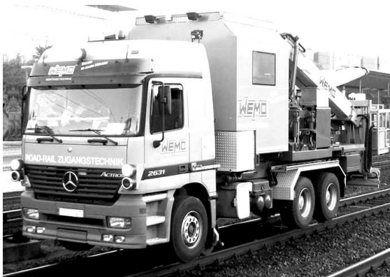
Abb.39: „Schienen-LKWs“ dienen heutzutage meistens der Sicherheit, z.B. bei der Feuerwehr und der Tunnelinspektion. Statt der festen Geräteaufbauten kann auf der Ladefläche natürlich auch eine Tragplatte für Container befestigt werden.
